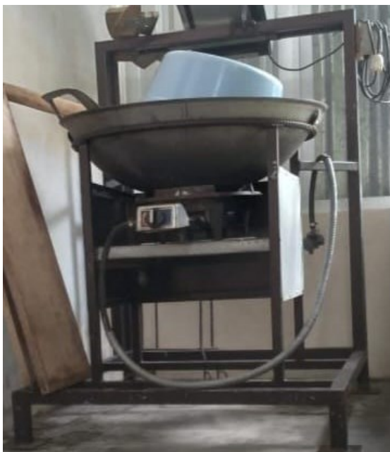
Gambar 4. (a) Alat untuk memanaskan air nira hingga mengental, dan (b) Oven khusus untuk mengeringkan air yang sudah mengental
