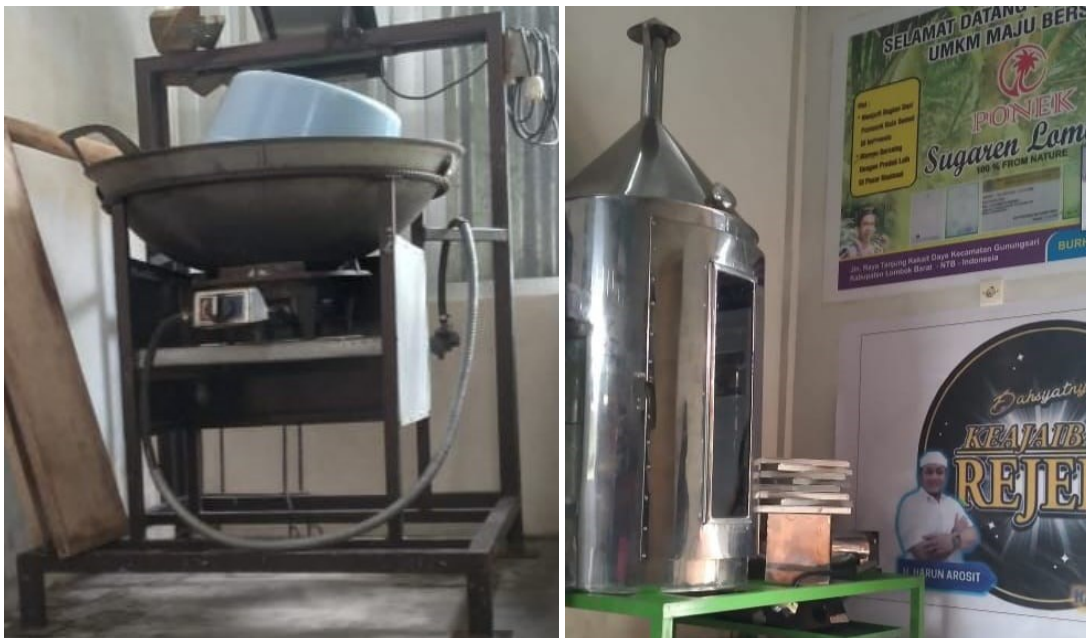
Gambar 4. (a) Alat untuk memanaskan air nira hingga mengental, dan (b) Oven khusus untuk mengeringkan air yang sudah mengental
